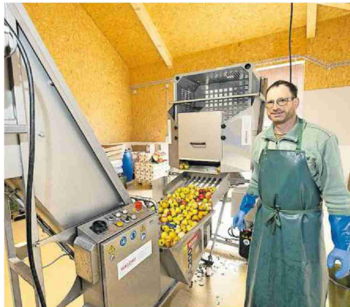
Nach der Ernte werden die Äpfel zuerst gewaschen und dann von einem Förderband in die Mühle befördert.
